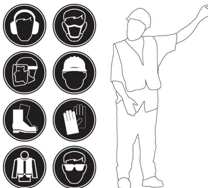
Рис. 2.1 – Типовые средства индивидуальной защиты для оператора
